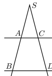
Willkürlich wähle ich für die weiteren Rechnungen den **linken** Holm aus. Die Strahlenabschnitte heißen dann  $\overline{SA}$  und  $\overline{SB}$ . Hierbei ist die Strecke  $\overline{SA}$  als Leiterholmlänge mit  $\overline{SA} = 2,6 \text{ m}$  bekannt, die Strecke  $\overline{SB}$  muss zunächst noch aus  $\overline{SB}$  und  $\overline{AB}$  berechnet werden.
