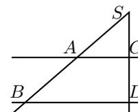
Bekannt sind die Strecken  $\overline{BD}$  als halbe Dachbodenbreite mit  $\overline{BD} = 4,75$  m, die Strecke  $\overline{SD}$  als Dachbodenhöhe mit  $\overline{SD} = 3,80$  m und die Strecke  $\overline{CD}$  als Leinenebene mit  $\overline{CD} = 2,00$  m.
