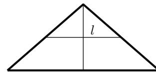
**Lösung:** Zur Lösung wird eine Hilfslinie eingetragen, die die Höhe des Dachbodens darstellt. Jetzt kann z. B. im linken Teildreieck der zweite Strahlensatz angewendet werden. Die beiden Strahlen sind die Höhe des Dachbodens und die Seitenlinie entlang der Dachfläche, die Parallelen sind der Fußboden des Dachbodens und die Wäscheleinenebene.
